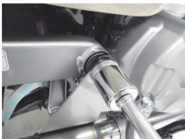
○サイレンサー上部のフランジ6角ボルトを規定トルクまで締め付けます。
