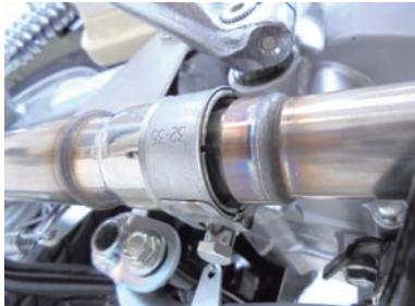
○クランプバンド90mmにバンドラバーを取り付け、マフラーASSY. サイレンサー部に、クランプバンド90mmを通し、サイレンサーにフランジ6角ボルト8x20、フランジナットを用いて取り付けます。
