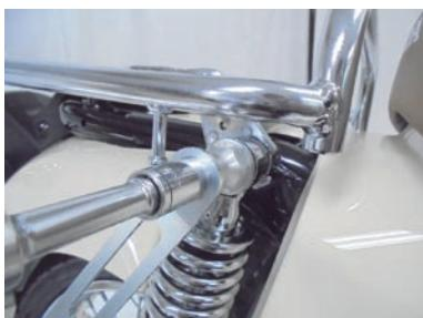
○サイレンサー部のフランジ6角ボルトを規定トルクまで締め付けます。
