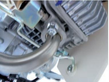
○右側リアショック部のピボットナットにキット内のサイレンサーステーをフランジ6角ボルト8x16を用いて取り付け仮締めします。
