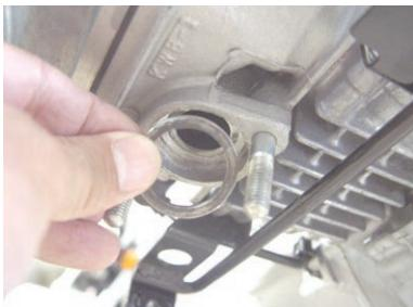
○右側リアショック上部ピボットナットを取り外し、キット内のピボットナットを取り付け、規定トルクまで締め付けます。
