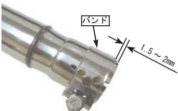
○マフラーASSY. ジョイント部のパッキンがパイプCOMP. ストップ部に当たるまで差し込み、マフラーASSY. ステー部をリアアクスルシャフトに、カラー、ピボットサイドプレート、マフラーステー、ワッシャ、リアアクスルスリーブナットの順で取り付け仮締めします。
