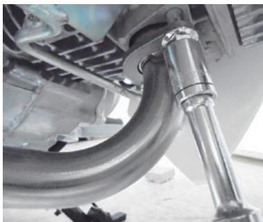
○マフラーASSY. ステー部のアクスルナットを規定トルクまで締め付けます
