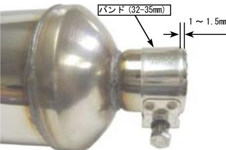
○サイレンサー ASSY. をキット付属のフランジ6角ボルト8x16を用いて仮付けします。
