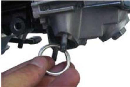
○右側リアショックの上部にピボットナットを取り付けます。
