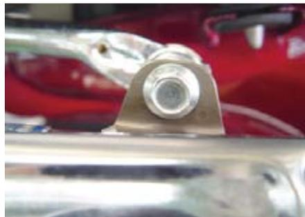
○サイレンサー ASSY. 前方のジョイント部のバンド(33-35mm)を規定トルクまで締め付けます。
