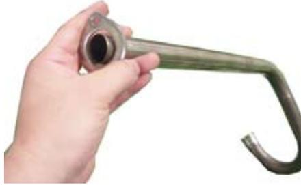
○取り付けしたマフラーに無理な力がかからない様調整し、エキゾーストパイプフランジ部のナットを均等に規定トルクまで締め付けます。
