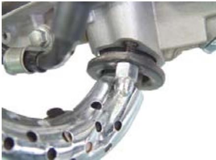
○マフラー本体を止めている2ヶ所の6角ボルトを取り外し、ノーマルマフラーを取り外します。
