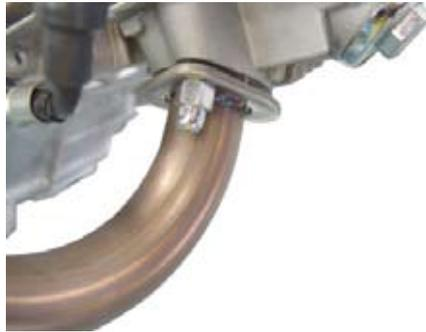
○サイレンサーステー部のフランジ6角ボルト8x16を規定トルクまで締め付けます。
