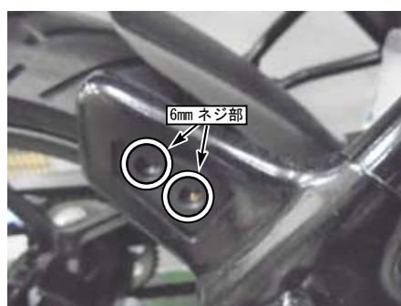
○取り付けた④ステー1COMP.にフレームを挟み込む様に、⑤ステー2COMP.を取り付け⑪フランジボタンヘッドソケットスクリュー6X15で取り付けます。
