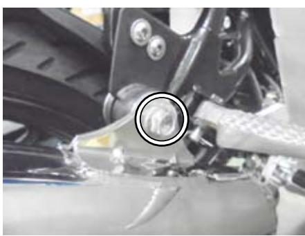
○③パイプ 2COMP. ジョイント部の⑧バンド 36-39mm を規定トルクまで締め付けます。
