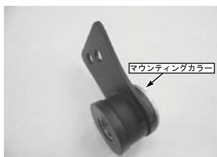
○マウンティングラバーを取り外したフレーム部に、キットの④ステー1COMP.のボス部をフレームのカラー部に車両側から差し込み、反対側からキットの⑥カラー、⑩ソケットキャップスクリュー8x20を用いて取り付けます。
