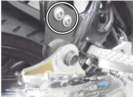
○エキゾーストパイプフランジ部のエキゾーストパイプボルト 2 本を規定トルクまで締め付けます。
