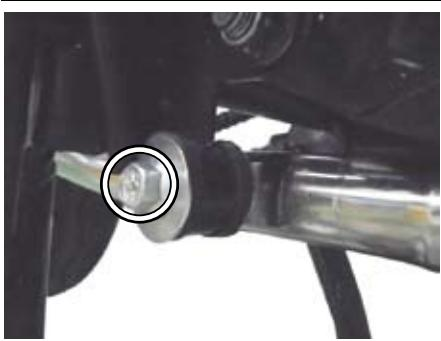
○①サイレンサー ASSY. のステー部のマウンティングボルトを規定トルクまで締め付けます。
