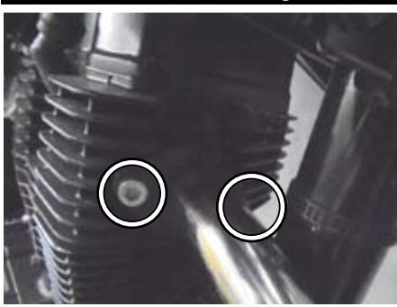
○③パイプ 2COMP. ステー部のマウンティングボルトを規定トルクまで締め付けます。
