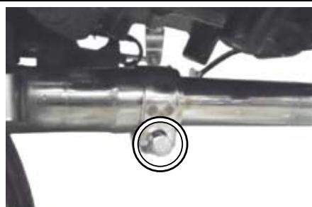
○①サイレンサー ASSY. のジョイント部の⑦バンド 44-47mm を規定トルクまで締め付けます。
