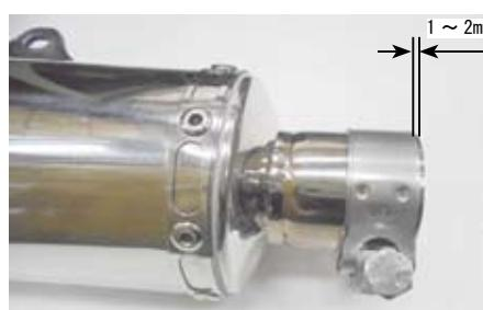
○③パイプ2COMP.のジョイント部に耐熱ガスケット剤を薄く塗布し、①サイレンサーASSY.を差し込み①サイレンサーASSY.のステー部を⑤ステー2COMP.に、ノーマルのマウンティングボルト、ワッシャ、フランジナットを用いて取り付け仮締めします。
