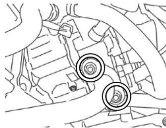
○⑥サイレンサーバンド部の下側の⑩ソケットキャップスクリュー 10x55 を規定トルクまで締め付けた後、上側の⑨ソケットキャップスクリュー 10x25 を規定トルクまで締め付けます。
