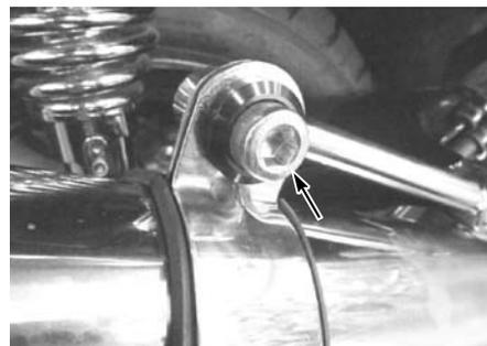
○③ステー COMP. の前方の⑩ソケットキャップスクリュー 10x30 を規定トルクまで締め付けます。
