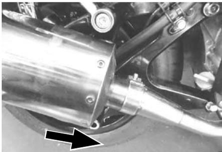
○①サイレンサー ASSY. に⑥サイレンサーバンドを両サイドから挟む様に取り付け、上部を③ステー COMP. のタップに⑨ソケットキャップスクリュー 10x25、⑤カラー、ボルトを用いて取り付け、下部はスイングアーム後方のタップ部に⑪ソケットキャップスクリュー 10x55、④カラー (23x10.5x10)、⑤カラー、ボルトを用いて取り付け仮締めします。
