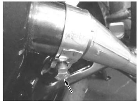
○マフラーに付着した汚れを良く拭き取り、サイレンサーのネームプレート及び認証プレートの保護フィルムを剥がします。
