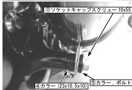
○⑥サイレンサーバンドの成型個体差により、
