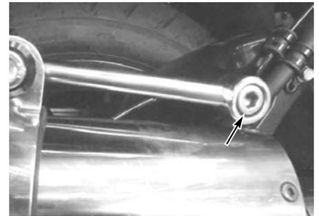
○①サイレンサー ASSY. ジョイント部の⑧バンド (44-47mm) を規定トルクまで締め付けます。
