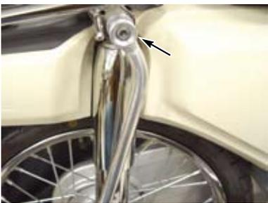
○サイレンサー部のソケットキャップスクリュー 10x25 を規定トルクで締め付けます。
