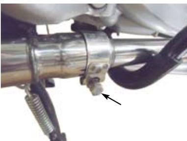
○サイレンサー ASSY. のジョイント部のバンド (44-47mm) を規定トルクまで締め付けます。
