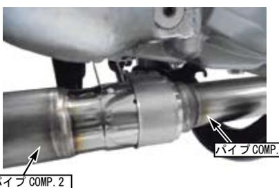
○パイプ COMP. 2 のステー部を下記写真を参考に取り付け、リアアクスルスリーブナットを仮締めします。
