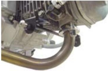
○右側リアショック部のピボットナットにサイレンサーステー、ソケットキャップスクリュー 8x25 を仮締めします。
