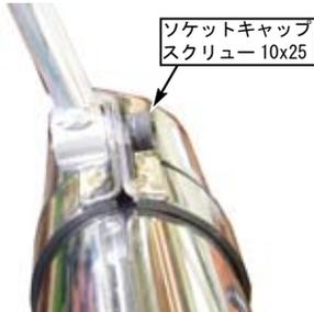
○パイプ COMP. 2 のジョイント部のバンド (32-35mm) を規定トルクまで締め付けます。
