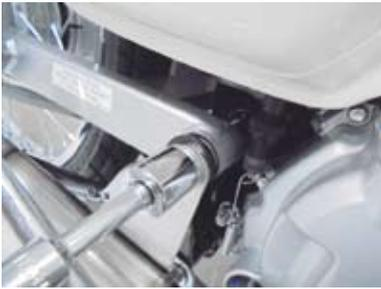
○マフラーステー上部のソケットキャップスクリューを規定トルクで締め付けます。
