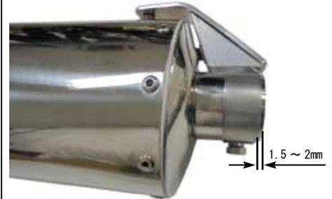
○サイレンサーバンドにサイレンサーバンドラバーを巻き付け、サイレンサー ASSY. に取り付け、付属のソケットキャップスクリュー 10x25、ブレンワッシャ 10mm を用いてマフラステー COMP. に取り付け仮締めします。
