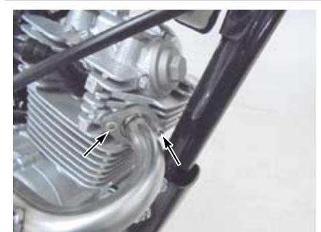
○③ステー COMP. 部の⑦フランジ 6 角ボルト 8x30 を規定トルクまで仮締めします。
