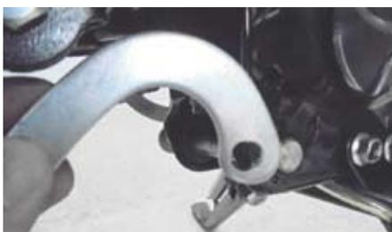
○メインスタンドシャフトを差し込み、ブレーキペダル、トーションスプリング、プレーンワッシャを元の取り付け状態に取り付け、キット付属の⑬割ピンを用いて取り付けます。
