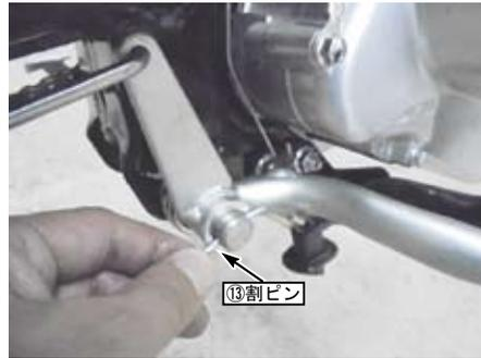
○右側のフットレストブラケットを取り外します。このマフラーは右側のフットレストブラケットを取り外す必要があります。バランスを考慮し、左側のフットレストブラケットも取り外す場合、リアアーム COMP. のピボットシャフトを取り外す必要があるため、リアホイール、リアアーム COMP. を取り外し左側のフットレストブラケットを取り外します。
