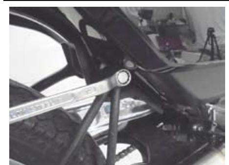
○②サイレンサー ASSY. ジョイント部のバンド (32-35mm) を規定トルクまで締め付けます。
