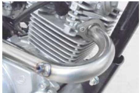
○②サイレンサー COMP. ジョイント部を①パイプ COMP. に差し込み、③ステー COMP. をフレームにキット付属の⑦フランジ 6 角ボルト 8x30 で仮締めします。
