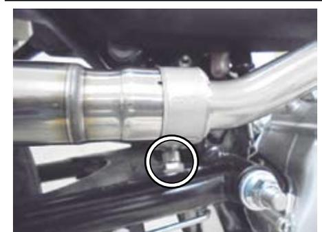
○①パイプ COMP. に⑧パイプ、プロテクターを⑩パッキンで挟み込み、キット内の⑨バインド小ネジ 6x12 用いて取り付け、規定トルクにて締め付けます。
