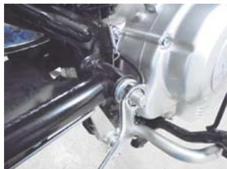
○このマフラーは、エアインダクションシステムは使用しませんので、エアインダクションシステムを取り外します。左右のサイドカバーを取り外し、シート ASSY. を取り外します。
