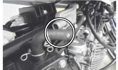
○エアインダクションシステムの取り付けボルトを外し、パイプごとフレームから取り外します。
