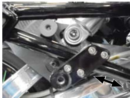
○①サイレンサー ASSY. のパイプ差込部に③バンド(44-47mm)を取り付けます。
