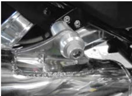
○②パイプ COMP. パイプフランジ部のジョイントナットを均等に規定トルクまで締め付けます。
