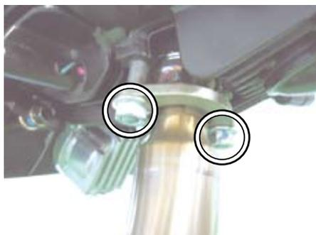
○①サイレンサー ASSY. のステー部の⑨ソケットキャップスクリュー 8x60 を規定トルクまで締め付けます。
