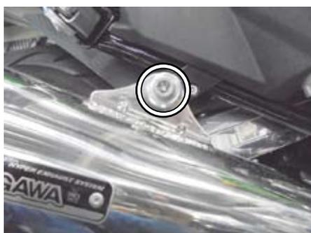
○①サイレンサー ASSY. ジョイント部の③バンド (44-47mm) を規定トルクまで締め付けます。
