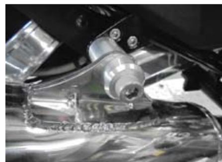
○①サイレンサー ASSY. ステーの穴と仮締めした⑥ステー1のM8ネジ穴が合う様、⑥ステー1の位置を調整し、⑨ソケットキャップスクリュー8x60を仮締めします。
