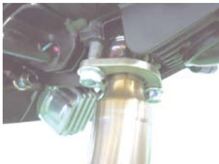
○キットの⑥ステー1と⑦ステー2をフレームのステー部のパイプに抱き込む様に取り付け、キットの⑧ソケットキャップスクリュー5x20を用いて仮締めします。
