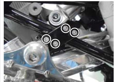
○一旦⑨ソケットキャップスクリュー8x60を取り外し、サイレンサー ASSY. を取り外します。
