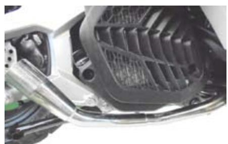
○ノーマルマフラーが取り付けられていたスイングアーム下側のタップ部に③ステーCOMP. を⑫ボタンヘッドソケットスクリュー10x35を用いて取り付け締め付けます。
