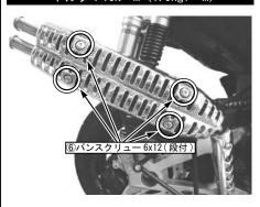
○認証プレートの保護フィルムを剥します。 ○マフラーに付着した汚れをよく拭き取ります。 〇エンジンを始動させ、排気漏れの有無を確認 します。
