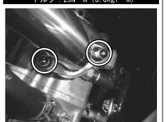
〇①マフラー COMP. ステー部の③フランジボルト 8x30 を規定トルクまで締め付けます。
