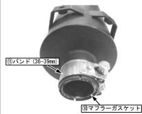
○②パイプ COMP. に①マフラー COMP. を差し込み、 ①マフラー COMP. 裏側のステー部を③ステー COMP. のカラ一部に③フランジボルト 8x30 2本 を用いて取り付け仮締めし、各部のクリアラン スを確認し、取り回しを調整します。
