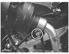
〇⑦パイププロテクターを⑨パッキンで挟み込み、 ⑧パンスクリュー 6x12 を用いて取り付け、 規定トルクにて締め付けます。
