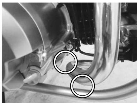
○②パイプCOMP. フランジ部のジョイントナットを手で一杯まで締め付けます。
