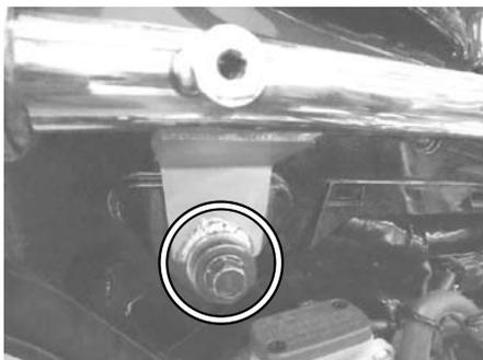
○②パイプCOMP. に①マフラーCOMP. を差し込み、リアショック部のアダプターボルトに①マフラーCOMP. をセットし、キャップナットを仮締めます。
