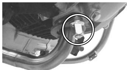
○②パイプCOMP. ステア部のマウントボルト及び①マフラーCOMP. ステア部、キャップナットを規定トルクまで締め付けます。
