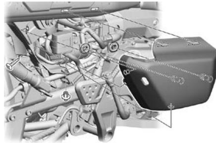
○アンダーカバーパイプのステーにアンダーカバーの爪を引っ掛けパンスクリューにて取り付けます。
