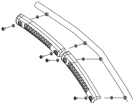
○③マフラープロテクターを①マフラーCOMP. にセットし、⑦プロテクターマウントラバーに⑩カラーを差し込み、⑨パンスクリュー6x12を用いて、③マフラープロテクターを①マフラーCOMP. に取り付けます。
