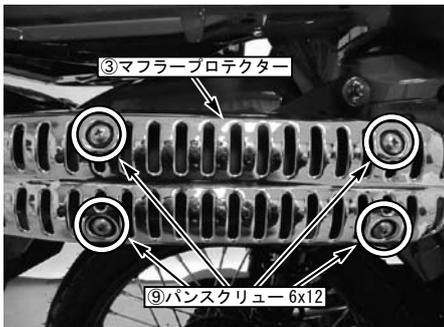
○④プロテクターとの位置関係を調整し、⑨パンスクリュー6x12を規定トルクにて締め付けます。
