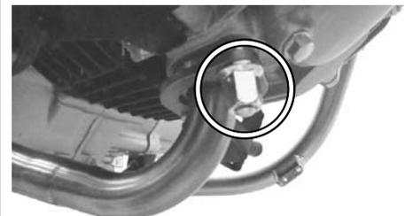
○①マフラーCOMP. ジョイント部の⑤バンド (32-35mm) を規定トルクまで締め付けます。
