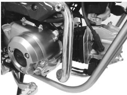
○②パイプCOMP. ステア部を車両側にマウントボルトにて仮締めます。
