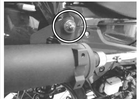
○②パイプCOMP. フランジ部のジョイントナットを均等に規定トルクまで締め付けます。
