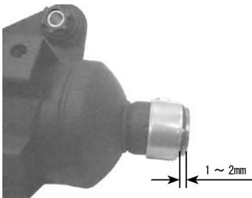
○シリンダーヘッドエキゾースト部に②パイプCOMP. をセットし、ジョイントナットにて仮締めます。
