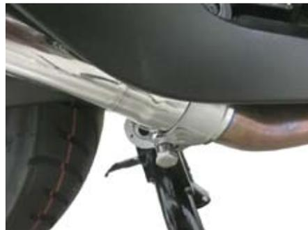
○①サイレンサー ASSY. ジョイント部の⑧バンド (44-47mm) を規定トルクまで締め付けます。
