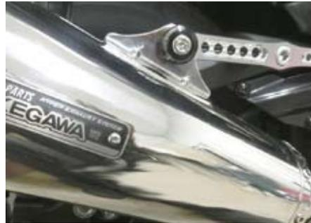
○②パイプ COMP. ジョイント部の⑦バンド (36-39mm) を締め付けます。
