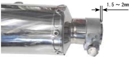
○取り付けした②パイプ COMP. のサイレンサー差し込み部に耐熱液体ガスケット剤を薄く塗布します。
