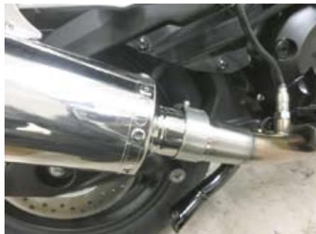
○③ステーのタップ部に⑥カラー、ボルト M8、⑫ソケットキャップスクリュー 8X25 を用いて①サイレンサー ASSY. のステー部を取り付けます。
