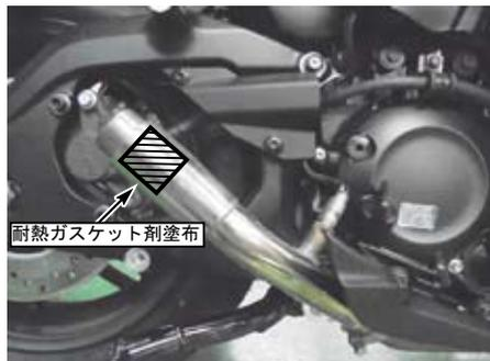
○①サイレンサー ASSY. ジョイント部を②パイプ COMP. に差し込みます。
