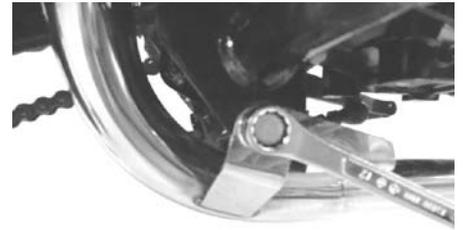
○①サイレンサー ASSY. のステー部の⑦ソケットキャップスクリュー 8x45 を規定トルクまで締め付けます。
