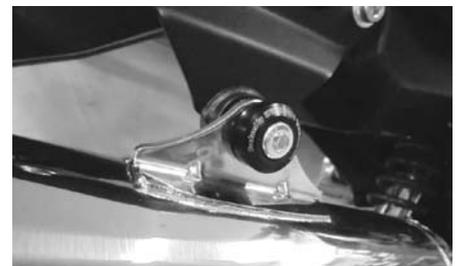
○①サイレンサー ASSY. のジョイント部の⑥バンド (44-47mm) を締め付けます。
