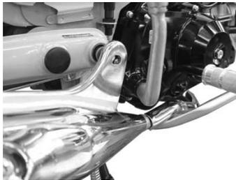
○エキゾーストポート部の古いエキゾーストパイプガスケットを外しキット内の⑤エキゾーストパイプガスケットを取り付けます。
