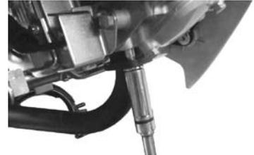
○④ステー部のマウントボルトを規定トルクまで締め付けた後、マフラーマウントナットを規定トルクまで締め付けます。
