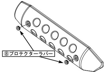
○①サイレンサー COMP. のボス部に、⑦マフラープロテクターを、⑨パンスクリューを用いて取り付け、締め付けます。
