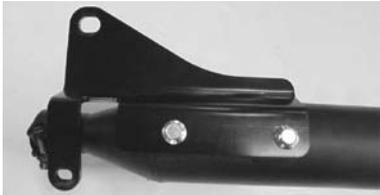
○①サイレンサーCOMP.に取り付けた④ステーをスイングアームピボットボルトに取り付け、ワッシャ、マフラーマウントナットを仮締めし、マウントボルトを仮締めします。
