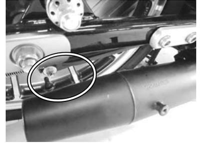
○シリンダーヘッドエキゾーストポート部のジョイントナットを規定トルクまで均等に締め付けます。
