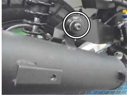
○①マフラー COMP. を車両外側に引き寄せジョイント部のバンドを締め付けます。
