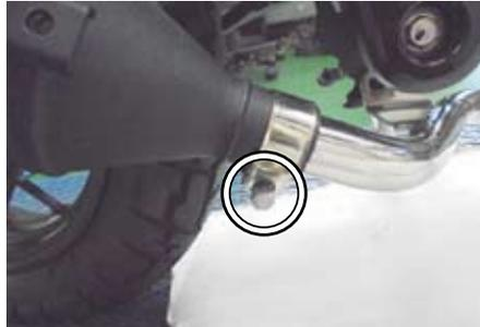
○取り外したノーマルのエキゾーストパイプからプロテクターを取り外し、ノーマルプロテクターラバーを④プロテクターに取り付けます。ノーマルプロテクターを取り付けていたパンスクリュー2個を用いて①マフラー COMP. に④プロテクターを取付けます。
