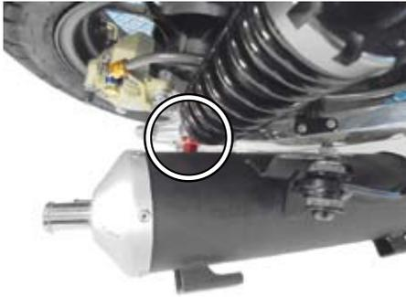
○②パイプ COMP. の⑨フランジナット 8mm を規定トルクまで締め付けます。
