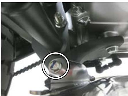
○①マフラー COMP. ステア部のボタンヘッドソケットスクリューを規定トルクまで締め付けます。
