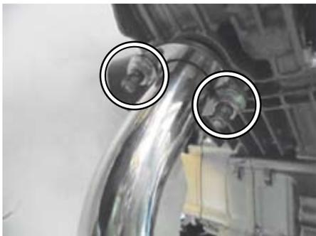
○②パイプ COMP. ステア部のマウントボルトを規定トルクまで締め付けます。
