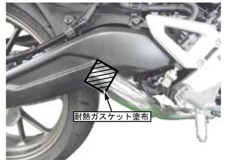
○⑧バンド (44-47mm) をセットし、③サイレンサーASSY. ジョイント部を②パイプCOMP. 2に挿入し③サイレンサーASSY. のステー部を⑨ボルトカラー、⑩ソケットキャップスクリーを用いて④ステーに仮締めします。
