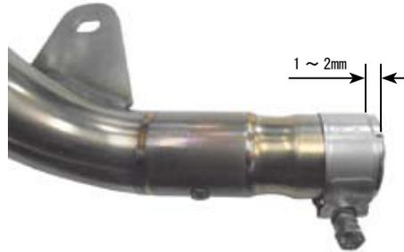
○①パイプCOMP. 1に②パイプCOMP. 2を挿入し、ステー部をノーマルマフラーが装着していたマウントラバー部にノーマルのマウントボルト、⑫フランジナットにて取り付け、仮締めします。
