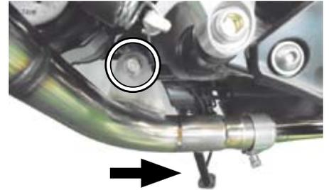
○②パイプCOMP. 2の③サイレンサーASSY. 差し込みジョイント部に耐熱ガスケット剤を塗布します。
