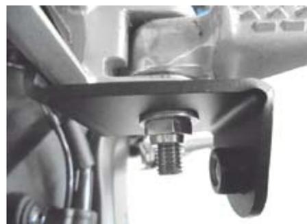
○⑪ハードロックナットをレンチで固定し、もう片側のハードロックナットを締め付けます。
