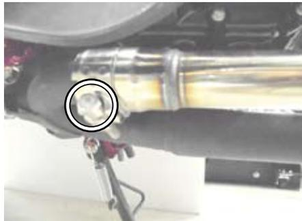
○ノーマルのエキゾーストパイププロテクターのラバー 2 個を利用し、⑩パイプヒートガードに取り付け、ノーマルのパンスクリューで②パイプ COMP. に取り付け締め付けます。
