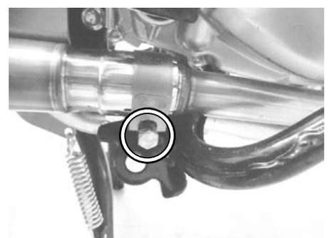
○サイレンサー部のネームプレート及び認証プレートの保護フィルムを剥します。
