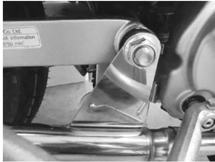
○サイレンサー⑤クランプバンド部の⑩フランジ 6 角ボルト 8x20 を規定トルクまで締め付けます。
