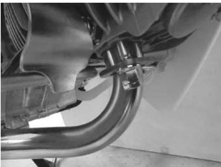
○右側リアショック部の⑫ピボットナットに④ステー COMP. を⑨ソケットキャップスクリュー8x25を用いて取り付け仮締めします。
