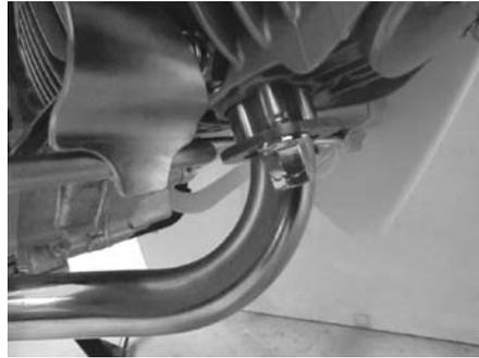
○①マフラー COMP. ステー部のフランジナットを規定トルクまで締め付けます。
