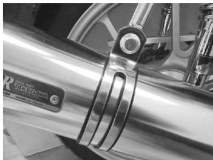
○④ステー COMP. 上部の⑨ソケットキャップ スクリュー 8x25 を規定トルクまで締め付けます。
