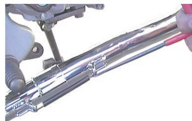
15. サイレンサー部のエンブレム及び JMCA プレートの保護フィルムを剥がします。
