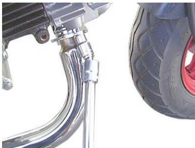
12. マフラスター上部のノーマルボルトを規定トルクで締め付けます。
