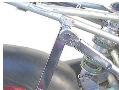
13. マフラーバンド部のボタンヘッドソケットスクリュー 8x20 を規定トルクで締め付けます。
