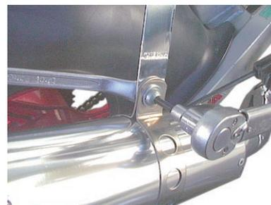
14. マフラーボディ COMP. とエキゾーストパイプ COMP. のフック部にエキゾーストジョイントスプリングをスプリングフック等の工具を用いて取り付けます。
