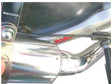
11. シリンダーヘッド EX ポート部のナットを均等に規定トルクで締め付けます。
