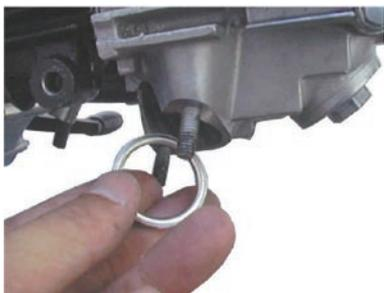
7. エキゾーストパイプ COMP. をシリンダーヘッド EX ポート部に差し込み、ノーマルナットを用いて仮締めします。
