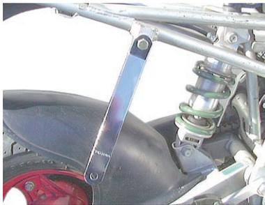
9. マフラーボディ COMP. をエキゾーストパイプ COMP. に差し込み、サイレンサー部にマフラーバンド、プレーンワッシャ、ボタンヘッドソケットスクリュー 8x20、フランジナット 8mm を用いて取り付け仮締めします。
