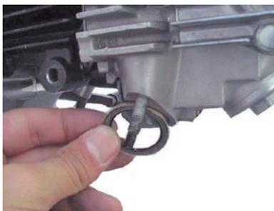
6. 新品のエキゾーストパイプガスケットをEXポート部に差し込み取り付けます。
