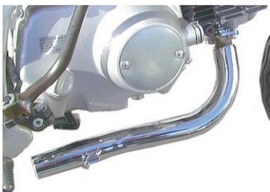
8. ノーマルマフラスター部が止まっていたフレームの 8mm ネジ部にマフラスターをノーマルボルトを用いて取り付け仮締めします。
