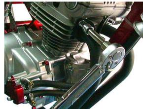
マフラーCOMP. のステー部のSTDボルトを規定トルクまで締め付けます。
