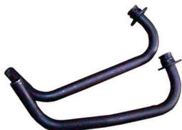
エキゾーストパイプ . L、エキゾーストパイプ . Rを、シリンダーヘッドエキゾーストポート部に、差し込みそれぞれSTDナットを用いて仮締めします。
