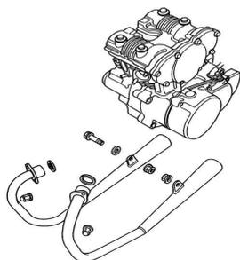
エキゾーストパイプガスケットを外し、KIT内の新品のエキゾーストパイプガスケットに交換します。
