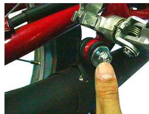
シリンダーヘッドエキゾースト部のエキゾーストパイプ . L、エキゾーストパイプ . Rのフランジ部のSTDナットを均等に、規定トルクまで締め付けます。
