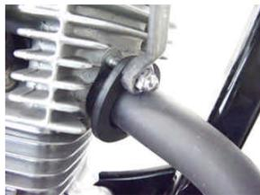
5. ボルトを取り外し、キックペダルを取り外します。
