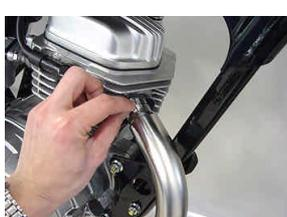
6. マフラーボディーCOMPをエキゾーストパイプCOMPに差し込み、サイレンサー部をクランプバンド、ボタンヘッドスクリーンM8 × 20、ブレンワッシャ、フランジナットを用いて仮締めします。
