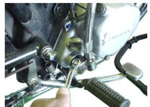
13. エンジンを始動させ、排気漏れの有無を確認します。
