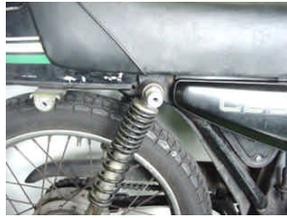
3. マフラステーをピボットナットに、ボタンヘッドスクリーンM8 × 15、ブレンワッシャを用いて仮締めします。
