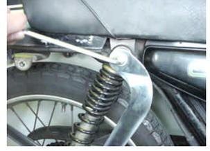
9. クランプバンド部のボタンヘッドスクリーンM8 × 20を規定トルクまで締め付けます。
