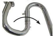
ジョイントスプリングをスプリングフック等の工具でエキゾーストパイプとマフラー COMP. に取り付けます。
