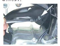
4. EX パイプ部のナット 2 個を取り外します。
