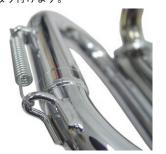
6. エキゾーストパイプをシリンダーヘッド EX ポート部に差込み、STD ナットを用いて仮締めします。
