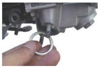
3. リアブレーキアーム、ピボット部の割ピンを プライヤー等で取り外し、ワッシャを取り外 します。
