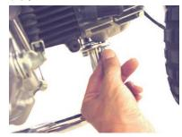
7. マフラー COMP. のステー部にキット内のストッパーカラーを差し込み、フレームのリアブレーキアームピボットシャフトに取り付けます。
