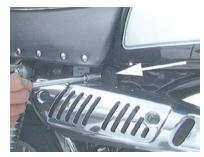
6. フランジのカラー 2 個を取り外し、外側に引く 様にしてマフラーを車体から取り外します。
