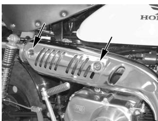
9. 純正マフラーガードと、マフラー本体やフレームとの干渉が無いか確認します。必要に応じて、各部スクリュー・ナットを緩め、マフラーに無理のかからない範囲で、位置を調整して固定して下さい。
