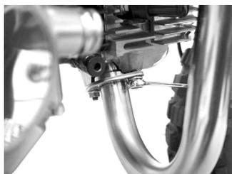
7. 次にサイレンサーステー部のフランジボルトを規定トルクまで締め付けます。
