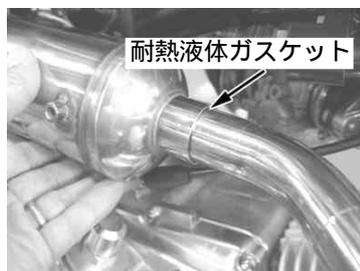
差し込み部分に耐熱液体ガスケットの塗布をお勧めします。
