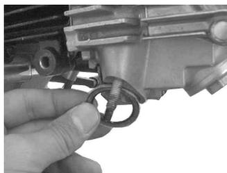
8. 取り外したエアクリーナーを、取り外しと逆の手順で取り付けます。
