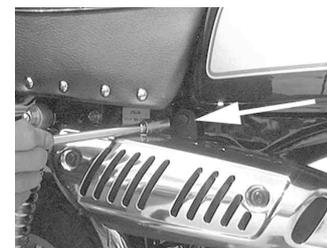
6. エキゾーストフランジのカラー2個を取り外し、外側に引くようにして、マフラーを車体から取り外します。
