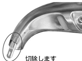
4. 切除した場合、切断面の錆止めの為、耐熱ペイントでタッチアップをされる事をお勧めします。
