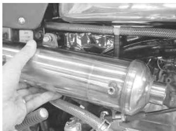
3. エキゾーストパイプCOMPを、サイレンサーASSYのジョイント部に差し込んでから、フランジ部をエンジンに差し込みます。
