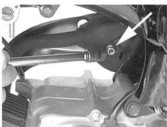
4. エキゾーストパイプフランジ部のナット2個を取り外します。
