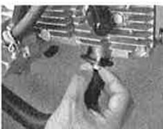
①マフラーCOMPをシリンダーへッドエキゾースト側に差し込みSTDナットを用いて仮締めします。
