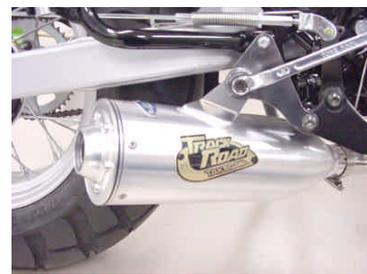
8. クランプバンドをサイレンサージョイント部に固定し、クランプバンドを規定トルクまで締め付けます。
