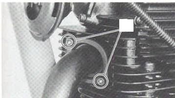
4. マフラーとエキゾーストパイプをジョイントしているマフラーバンドを緩め、マフラー本体を止めているボルトを取り外し、マフラーを取り外します。
