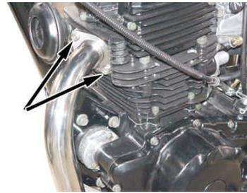
7. マフラステー部のフランジボルトを規定トルクまで締め付けます。
