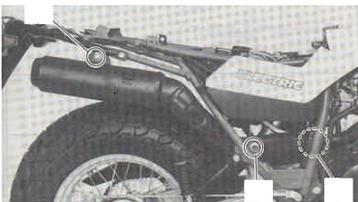
5. エキゾーストポート部から古いエキゾーストパイプガスケットを取り外し、付属の新品のエキゾーストパイプガスケットを取り付けます。
