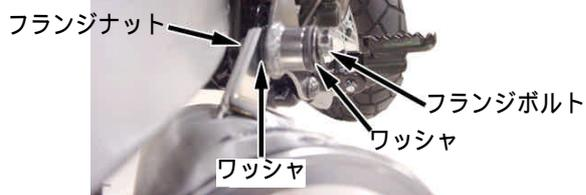
6. エキゾーストポート部の2本の S T Dボルトを均等に規定トルクまで締め付けます。
