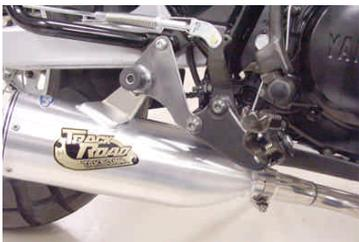
5. サイレンサーCOMPステー部をマフラステー裏側に合わせ、K I T内のプレーンワッシャ、フランジボルト、フランジナットを用いて取り付け、仮締めします。
