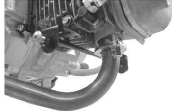
2. 右側リアショック部のピボットナットにキット内のカラー、サイレンサーステ-をフランジボルト8x20を用いて取り付け仮締めします。
