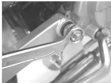
8. サイレンサーステ - 上部のフランジボルトを規定トルクまで締め付けます。
