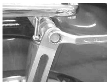
9. サイレンサーバンド部のフランジボルトを規定トルクまで締め付けます。
