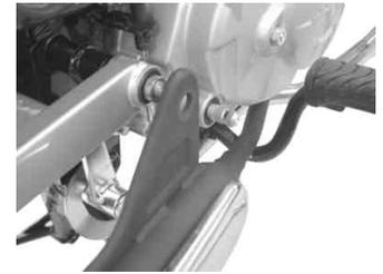
6. 右側リアショック上部ピボットナットを取り外し、キット内のピボットナットを取り付け、規定トルクまで締め付けます。
