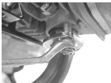
7. マフラーステCOMP.ステ部のアクスルナットを規定トルクまで締め付けます。
