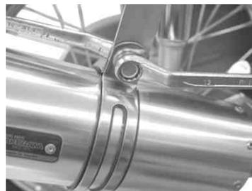
10. サイレンサー部のネームプレート及び認証プレートの保護フィルムを剥します。
