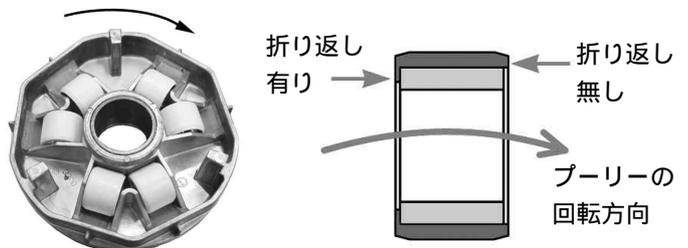
△注意：逆向きに取り付けた場合、ウェイトローラーが磨耗してくると、ウェイトローラーのインナーとプーリーが接触し、プーリー内のウェイトローラー摺動面に傷を付け、変速不調及びプーリー損傷の原因となる恐れがあります。
