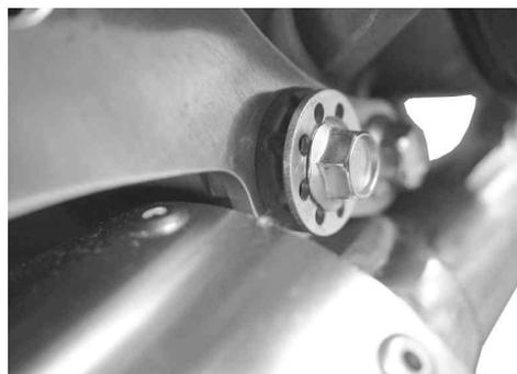
7. エキゾーストパイプナットを規定トルクで締め付けます。
