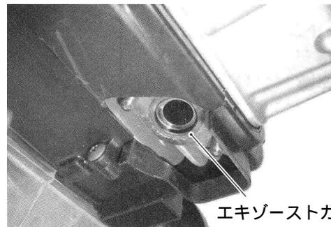
4. 純正マフラーからO<sub>2</sub> センサーを外します。
