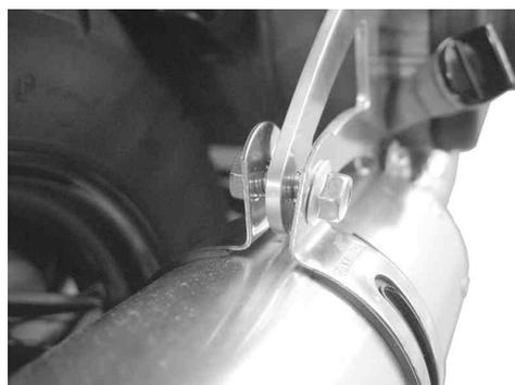
6. ステーに取り付けたカラーにフランジボルト6×2.5を通し、フランジナットM6を用いてマフラーCOMP.のエキゾーストパイプ部を取り付け、仮締めします。
