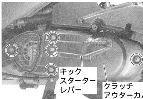
3. クラッチカバーボルトを取り外し、クラッチカバーを取り外します。
