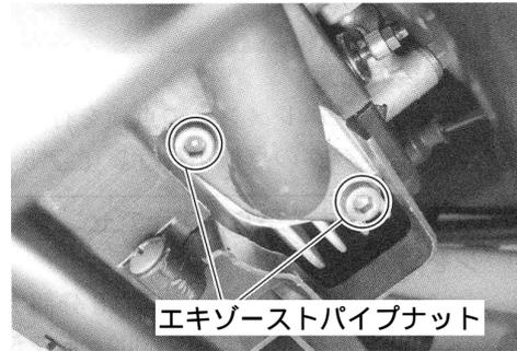
2. マフラーをエンジンに固定しているマフラークランプボルト2本を取り外し、純正マフラーを取り外します。
