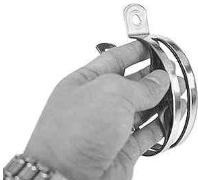
5. ステーとサイレンサーバンドをフランジボルト8×2.0及びフランジナットM8を用いてステーを挟む様にして取り付け、仮締めします。
