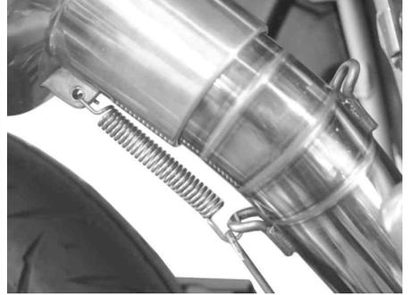
16. サイレンサー部のJ M C Aプレートに保護フィルムが貼ってあるので、そのフィルムを剥がします。
