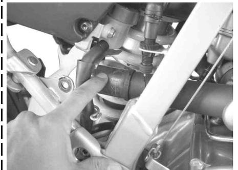
9. キット内のパイプCOMP をエキゾーストパイプに差込み、マフラー取り付けボルトフロントを取り付け仮締めします。
