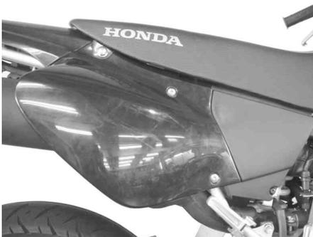
4. マフラー取り付けボルトフロントを取り外します。
