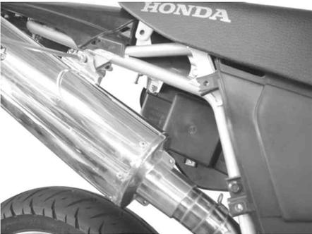
12. 緩めたエキゾーストパイプジョイントナットを規定トルクまで均等に締め付けます。
