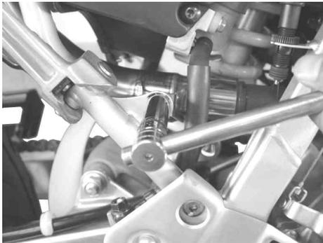
15. キット内のジョイントスプリングをサイレンサーCOMP とパイプCOMP のスプリングフック部にスプリングフック等の工具を用いて取り付けます。
