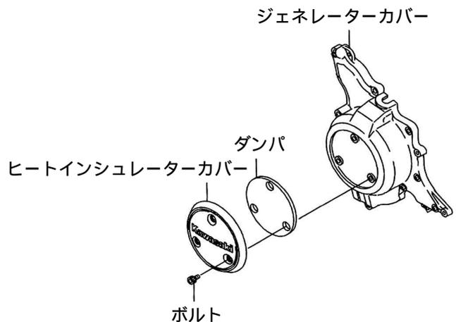
1. ヒートインシュレーターカバーのボルト3本を外し、ヒートインシュレーターを取り外します。
