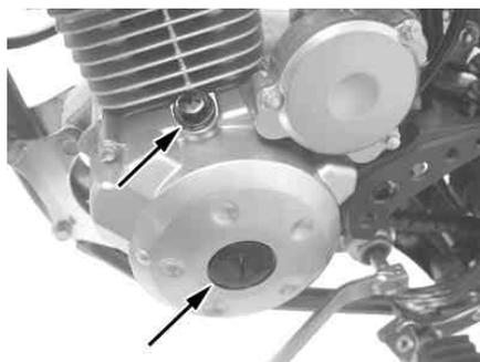
2. 付属のOリングにエンジンオイルを少量塗りジェネレータープラグの溝にセットします。
