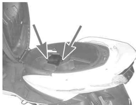
2. トランクをフレームに固定しているスクリー4本を取り外して、トランクを車両より取り外します。
