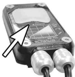
△注意：ラバーキャップは確実に取り付けして下さい。取り付け時に、ラバーがスイッチに乗り上げたりすると、ラバーキャップとF Iコントローラー本体パネル面に隙間が生じ、ラバーキャップの脱落や、隙間から埃や水などが浸入し、F Iコントローラー本体が故障する原因となります。
