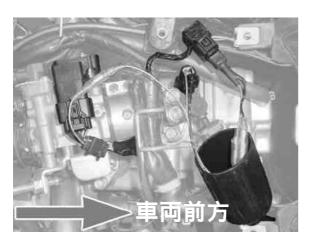
ハーネスカバーMの中に、サブコード - 2 C o m p .及び 純正フューエルインジェクタコネクタを収納し、走行時の振動などで 損傷しないように保護してコードを取り回します。
