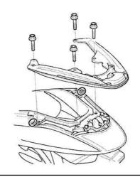
① 注意:ボルト4本を締め付ける際は、必ず規定トルクを守る事。トルク:27N・m(2.8kgf・m)
