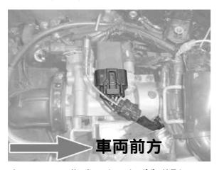
ハーネスComp.の 黄/青コード のオスギボシ端子を、 先ほどエレクトロタップで取り付けたサブコード - 2 (黄/青)に 接続します。
