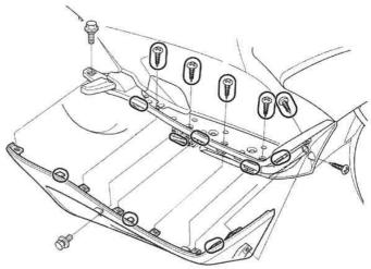
・フロアステップを取り外します。
