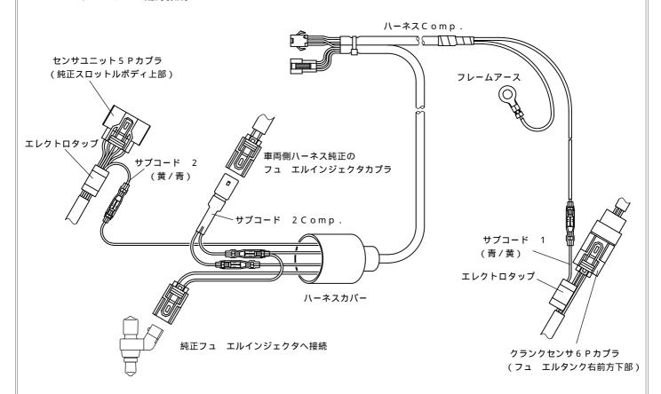
図中番号の順に、注釈を確認しながら作業を行って下さい。 なお、本取扱説明書中のコード色表記は、ベース色 / ライン色としています。 青/黄という表記のコードは、青色の被覆に黄色のラインが入っているコードを表します。 フューエルタンク右前方下側あたりにある、 純正のクランクセンサ6 Pカプラ 青/黄コード に、 サブコード - 1 (青/黄)をエレクトロタップで接続します。
