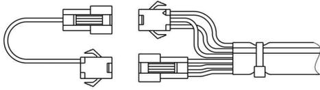
△注意：ハーネスCOMP の3Pコネクタ同士を直接接続しないで下さい。純正ECU破損の原因となります。
