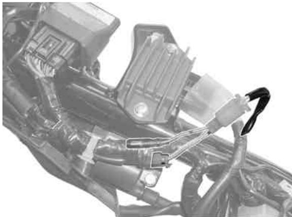
エンジン上部 純正スロットルボディ部 スロットル開度センサ 黒色3Pカブラの 白/赤コードに、サブコード(白/赤)をエレクトロタップで接続します。(ビニールチューブを少し切り開く必要があります)
