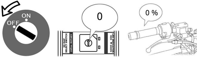
2. キーをONにします。赤と緑のLEDが同時に点灯し、赤LEDが2回点滅した後、赤・緑ともに消灯します。
