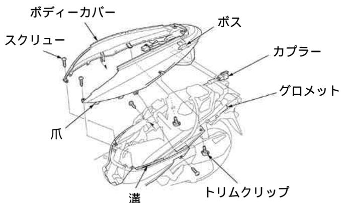
2. フロントアップカバーを取り外し、バッテリーマイナス端子の接続を外しておきます。
