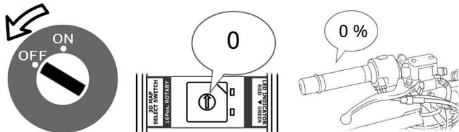
2. キーをONにします。赤と緑のLEDが同時に点灯し、赤LEDが3回点滅した後、赤・緑ともに消灯します。
