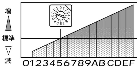
FIコン2は車両個体差やお好みに合わせて、選択したMA Pの補正值をロータリースイッチの設定で増減調整する事が出来ます。
