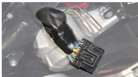
④ 純正インジェクタ 2P カプラを外し、ハーネス Comp. の 2P カプラ (32600-KZR-T00 と刻印されている物) に接続します。ハーネス Comp. の 2P カプラ (赤・黒コードが出ている物) を、純正インジェクタに接続します。
