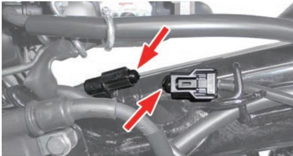
車両右側面、イグニッションコイルの奥にある O<sub>2</sub> センサ 1P カプラの接続を外し、キット付属のキャップφ6（小さい方）をメインハーネス側に、キャップφ7.5（大きい方）を O<sub>2</sub> センサ側のカプラに挿入して下さい。
