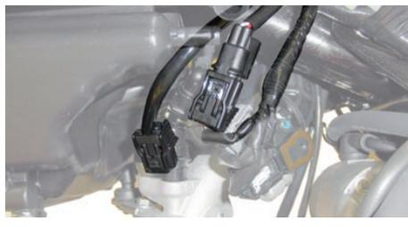
⑥ ハーネス Comp. の青/黄コード及び黄色コードのオスギボシ端子を、最初にエレクトロタップでメインハーネスに取付したサブコードに、同じ色同士を接続します。
