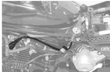
純正インジェクタ2Pカプラを外し、ハーネスComp.の2Pカプラ(32600-KZR-T00と刻印されている物)に接続します。ハーネスComp.の2Pカプラ(赤・黒コードが出ている物)を、純正インジェクタに接続します。
