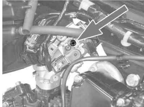
△注意：アイドルエアスクリュを回す時は、元の位置に戻せるように純正位置からどれだけ回したかを記録し、一度に1/4回転(90度)以上回転させない様に少しずつ様子を見ながら調整して下さい。
