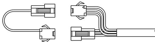
△注意：ハーネスComp .の3Pコネクタ同士を直接接続しないで下さい。純正ECU破損の原因となります。
