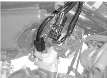
フレームアース用丸アース端子を、ガソリタンク後方の純正アースポイントに共締めします。
