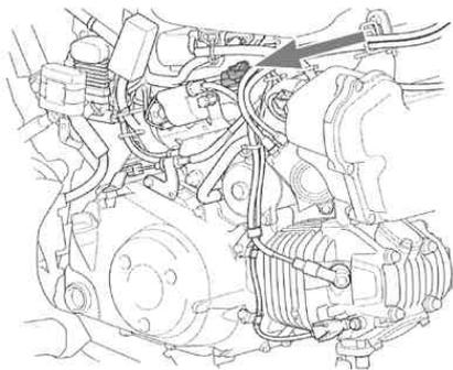
F Iコン2使用時は、純正のO<sub>2</sub>センサーフィードバック制御を使用しませんので、O<sub>2</sub>センサカブラの接続を外します。
