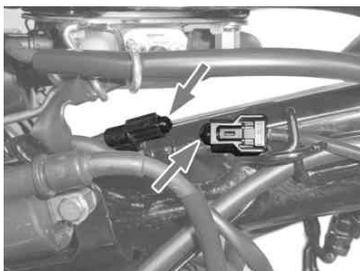
車両右側面、イグニッションコイルの奥にあるO<sub>2</sub>センサ1Pカブラの接続を外し、キット付属のキャップ 6 (小さい方) をメインハーネス側に、キャップ 7 .5 (大きい方) をO<sub>2</sub>センサ側のカブラに挿入して下さい。
