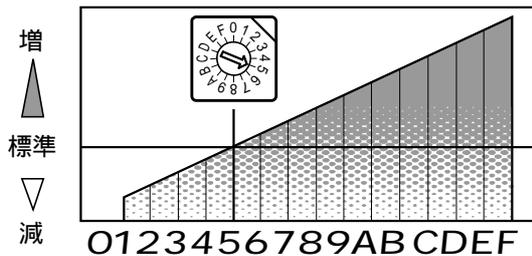
F Iコン2は車両個体差やお好みに合わせて、選択したMAPの補正値をロータリースイッチの設定で増減調整する事が出来ます。
