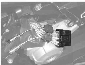
メインハーネスに取り付けたエレクトロタップがなるべく隠れるように純正のハーネスカバーでカバーし、純正ECUにコネクタを元通り確実に接続します。
