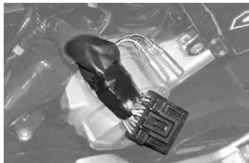
キット付属のハーネスComp. 2Pコネクタ2種類が純正のインジェクタコネクタに接続出来るようにし、車体左側面のメインハーネスと共に車両後方へ這わせませす。
