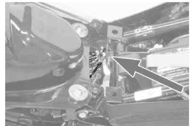
ハーネスComp.の青/黄コード及び黄色コードのオスギボシ端子を、最初にエレクトロタップでメインハーネスに取付したサブコードに、同じ色同士を接続します。
