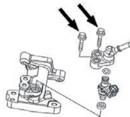
②燃圧を抜き、インテークパイプから、フューエルインジェクタジョイントマウントボルト 2本を取り外し、純正のフューエルインジェクタとフューエルインジェクタジョイントを取り外します。
