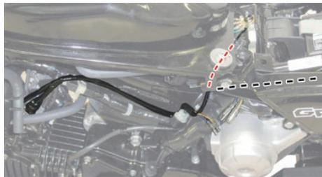
④ 純正インジェクタ 2P カプラを外し、ハーネス Comp. の 2P カプラ（32600-KZR-T00 と刻印されている物）に接続します。ハーネス Comp. の 2P カプラ（赤・黒コードが出ている物）を、本キット付属のインジェクタに接続します。
