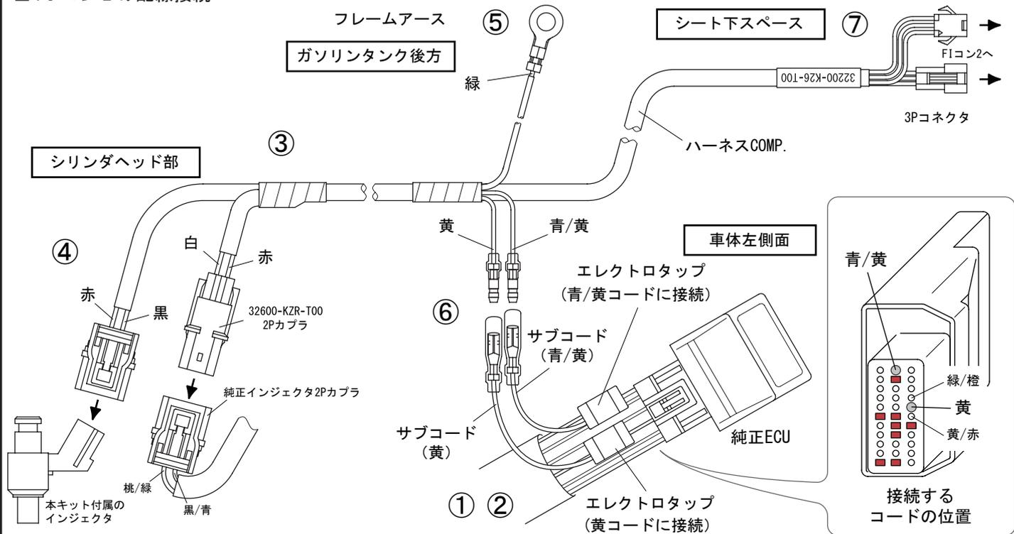
① 純正 ECU に接続されているメインハーネスのコネクタを抜き、メインハーネスのカバーを開いて、キット付属のサブコード 2 本（青/黄コード）（黄コード）を、メインハーネスの同色コードにそれぞれエレクトロタップで接続します。
