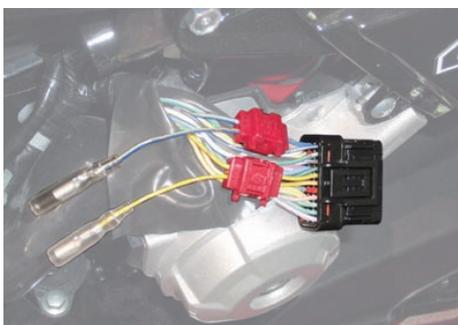
③ キット付属のハーネス Comp. 2P コネクタ 2 種類が純正のインジェクタコネクタに接続出来るようにし、車体左側面のメインハーネスと共に車両後方へ這わせませす。
