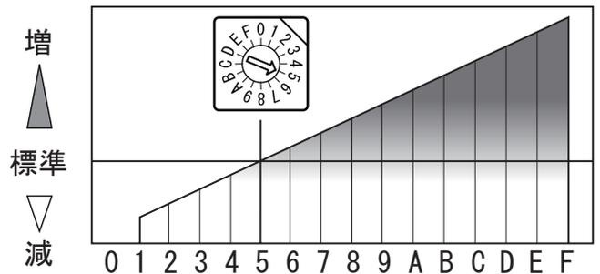
FI コン 2 は車両個体差やお好みに合わせて、選択した MAP の補正値をロータリースイッチの設定で増減調整する事が出来ます。
