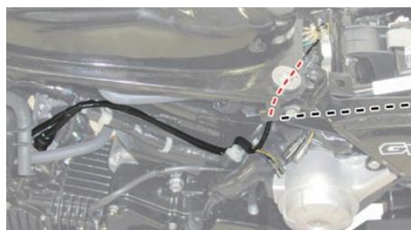
⑤ フレームアース用丸アース端子を、ガソリタンク後方の純正アースポイントに共締めします。
