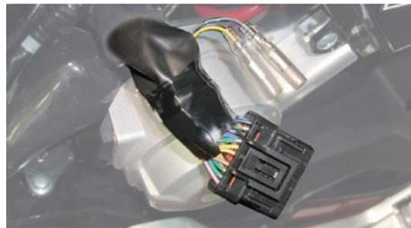
④ 純正インジェクタ 2P カブラを外し、ハーネス Comp. の 2P カブラ（32600-KZR-T00 と刻印されている物）に接続します。ハーネス Comp. の 2P カブラ（赤・黒コードが出ている物）を、純正インジェクタに接続します。
