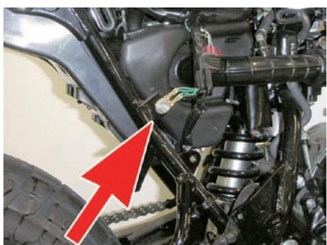
⑥ ハーネス COMP. の青/黄コードと黒/白コードのオスギボシ端子を、最初にエレクトロタップでメインハーネスに取り付けたサブコードのメスギボシ端子に接続します。ハーネス COMP. の青/黄コードをサブコードの同色コードに接続し、ハーネス COMP. の黒/白コードをサブコード(黄コード)に接続して下さい。
