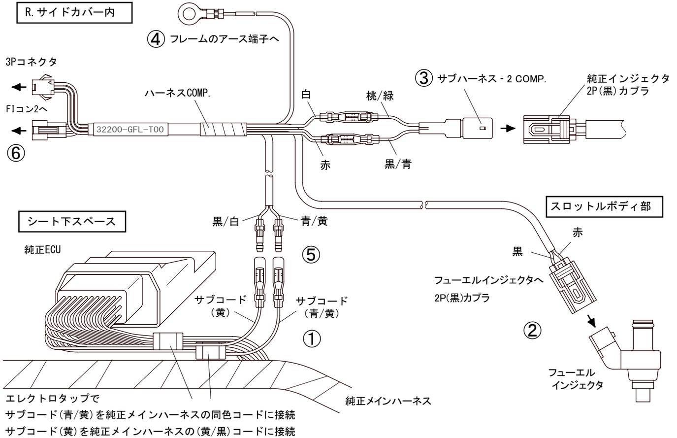
① 純正 ECU に接続されているメインハーネスのカバーを開いて、キット付属のサブコード(青/黄コード)を、メインハーネスの同色コードに接続し、サブコード(黄コード)をメインハーネスの黄/黒コードへ、それぞれエレクトロタップで接続します。
