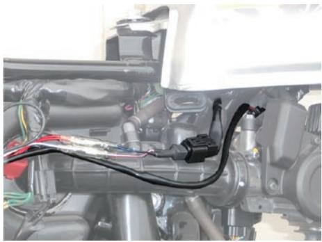
⑤ フレームアース用丸アース端子を、R. サイドカバー内フレームのボルト/アース端子に共締めします。
