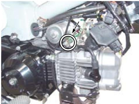
○スロットルボディに取り付けられているスロットルドラムカバーの固定スクリュー2本を取り外し、カバーを取り外します。
