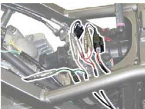
○アースコードの丸端子を、フレーム左前方のアースポイントに共締めします。
