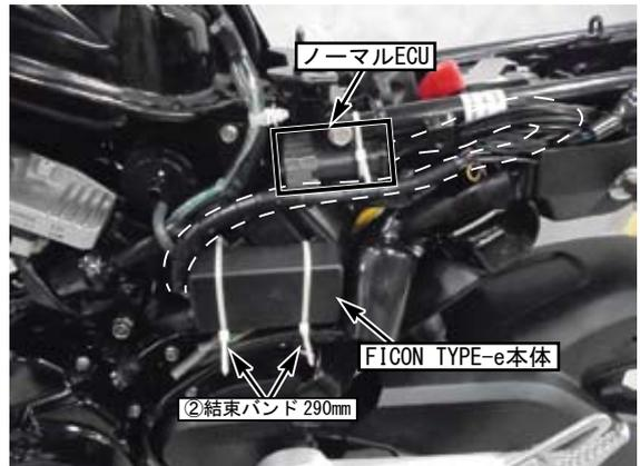
○L. フューエルタンクサイドカバーとL. サイドカバーを仮組みし、FI コン TYPE-e 本体の位置を定めます。位置が定まれば②結束バンド 290mm をしっかり固定していきます。
