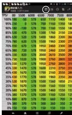
画面右上○部から「FICON から吸出」をタップし FI コン TYPE-e 又は TYPE-X と接続し、Map を開き編集したい箇所をタップし、タップした箇所がグレーに変わったら、グレー箇所をもう一度長押しでタップします。
