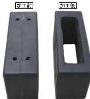
○写真を参考に①FI コンTYPE-e に加工したエンジンコントロールサスペンションを通します。
