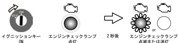
※エンジンチェックランプが点灯しない場合はハイパー ECU の取り付け、ヒューズの溶断などを確認して下さい。
