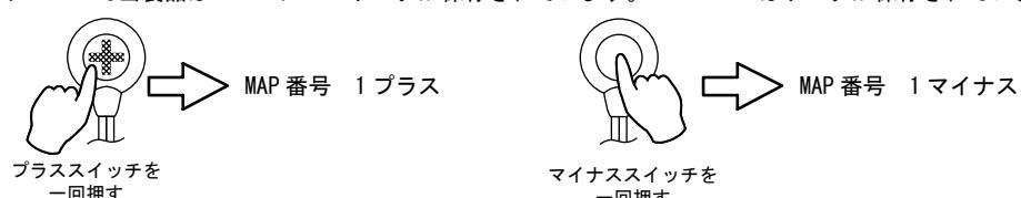
6. 目標の MAP 番号にしましたらプラススイッチ、マイナススイッチを同時に押します。押すと点滅が消えて選択された MAP が確定します。
