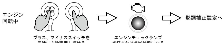
3. プラススイッチを押す度に濃い方向に1%ずつ増え、マイナススイッチを押す度に薄い方向に1%ずつ減ります。
