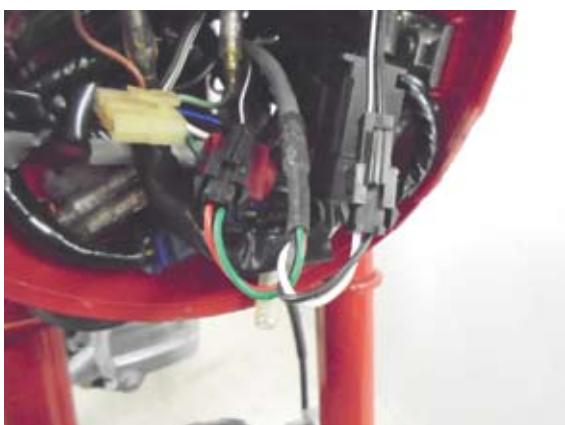
○バッテリーにバッテリーコネクタを接続し、外したシートと左サイドカバーを取り付けます。
