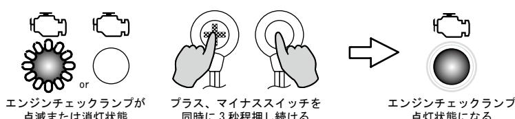
3. エンジンチェックランプが点灯状態でプラススイッチを一回押します。FI インジケーターランプが 1 秒毎で点滅します。
