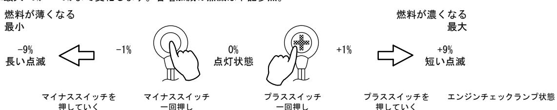
※設定中は設定値がインジェクター出力に反映します。適正な空燃比になる様に調整して下さい。
