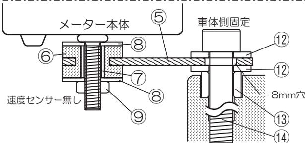
⑤メーターステーの固定穴はM8ボルト用ですので、M6ボルトで固定する時は⑫大径ワッシャーM6用(6X16X1.6)を挟んで下さい。
