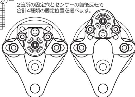
2箇所の固定穴とセンサーの前後反転で合計4種類の固定位置を選べます。
