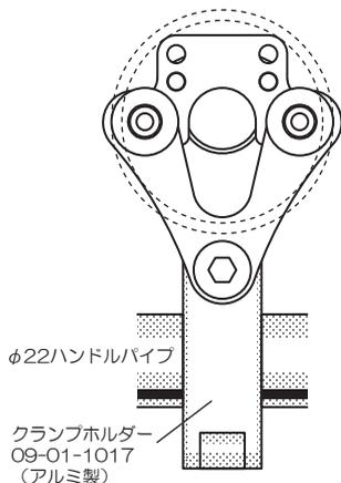
[速度センサーステー90°ベンドタイプ]使い、別売のウインカーステーと組み合わせてフロントフォークに速度センサーをクランプ。
