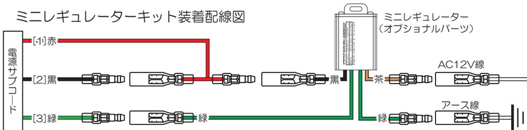
電装類の改造車や電圧確認の知識の無い方は、万が一の過電圧に対して40Vまでの電圧を制御する別売のミニレギュレーターキット (05-06-0014) の同時装着を推奨します。
