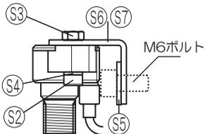
[速度センサーステー]の固定穴はM8ボルト用ですので、M6ボルトで固定する時は[大径ワッシャーM6用]を挟んで下さい。
