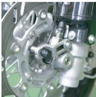
付属の6 角穴付き止めネジは、速度センサーブラケットに差し込み、金属反応式温度センサーの固定に使用します。
