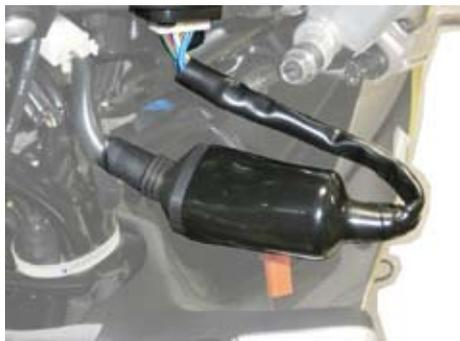
6. スーパーマルチ LCD メーター裏面から出ている白色 4 ピンコネクタに、キット付属の外付けアダプタを接続します。
