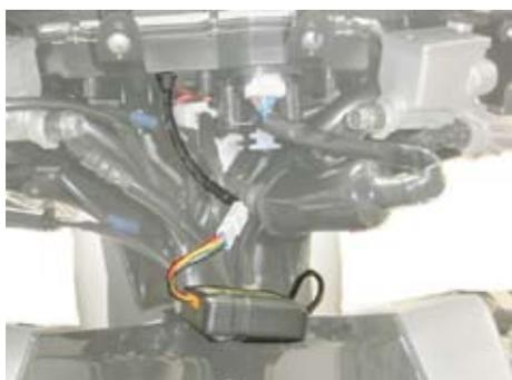
7. 外付けアダプタの 3P コネクタが付いたコードを、車両のメインハーネスと共に車両後方のバッテリー部まで這わせて、バッテリー後方よりケーブルが入る穴を利用して、トランクスペース内に 3P コネクタを通します。
