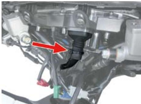
5. 変換ハーネス（灰色コネクタ側）を、車両のメーターハーネスに接続します。
