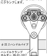
[S6 速度センサーステー 90° ベント] 使い、別売のウイン カーステーと組み合わせてフロントフォークに速度セン サーをクランプ。
