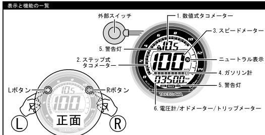
■ ADJモード時 短押し:次設定項目に進む 長押し:ADJモードを抜ける
