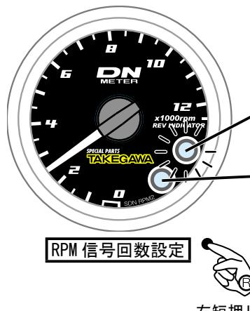
RPM 信号回数 1, 2, 3, 4 のいずれかに変更
