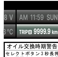
オイル交換時期警告 セレクトボタン 3 秒長押しで数値をクリアにする事が出来ます。
