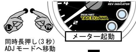
ADJ モードに入ります。L ボタン (セレクトボタン) 2 回単押しすると、RPM 信号種類設定になります。設定中は赤 LED が点滅、黄色 LED が点滅します。R ボタン (アジャストボタン) 単押しすると指針が 0、1 の順に移動します。タコメーターの指針が正常作動する方に設定します。決定した場合は L ボタン (セレクト) 単押ししてメイン画面に戻ります。(※この状態では、メーター本体に記録されません。キー OFF しないで下さい。RPM 信号種類設定のみの設定の場合は、L ボタン (セレクトボタン) 単押ししてメイン画面に戻ります。)
