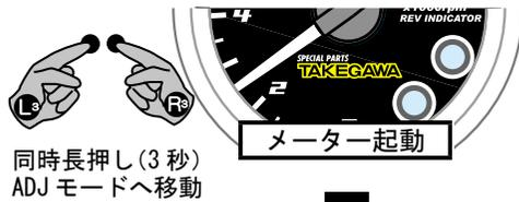
ADJ モードに入ります。L ボタン (セレクトボタン) 単押しすると、RPM 信号回数設定になります。設定中は赤 LED が点灯、黄色 LED が点滅します。R ボタン (アジャストボタン) 単押しすると指針が 1、2、3、4 の順に移動します。ご自分の車両の発火数に合わせて。決定した場合は L ボタン (セレクト) 単押しして RPM 信号種類設定へ移動 (※この状態では、メーター本体に記録されません。キー OFF しないで下さい。RPM 信号回数設定のみの設定の場合は、L ボタン (セレクトボタン) 単押し 2 回でメイン画面に戻ります。)
