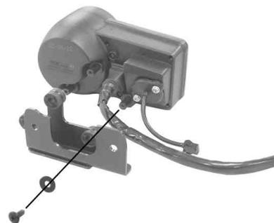
4. 組み立てたスーパーマルチLCDメーターと、メーターステアComp.を、純正のスピードメーターブラケットに取り付けます。写真を参考に、ソケットキャップスクリュー5×2.0に、ブレンワッシャM5とスペーサーを通して、純正のラバー部分に下側から通し、組み立てたメーターステアComp.を取り付け、フランジナットM5で固定します。
