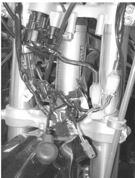
4. スピードメーターブラケット裏面からメーターを固定しているナットを取り外し、スピードメーターブラケットから純正メーターユニットを取り外します。
