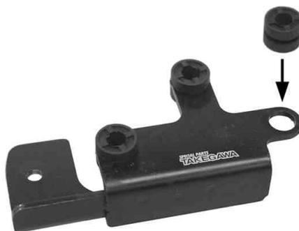
3. スーパーマルチLCDメーター本体を、先程ラバーを取り付けたメーターステアComp.に差込み、ブレンワッシャ4mmを通したタッピングスクリュー(3本)で固定します。
